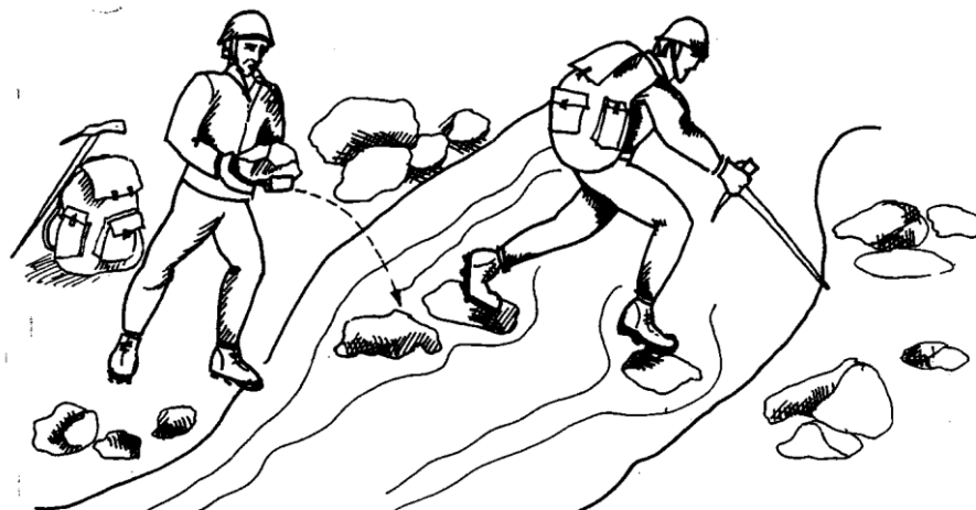
Рис. 16 Устройство дополнительной каменной наброски
