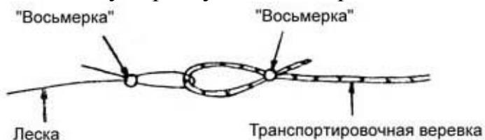
Рис. 4. Связывание лески и транспортировочной веревки
