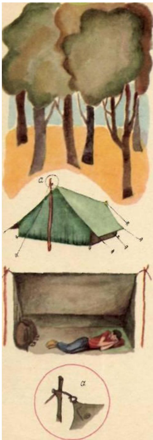
Опорную стойку произвольной длины можно ставить не в палатку, а под веревку оттяжки. Свободный вход — «занавеску» — изнутри придавливают рюкзаком
